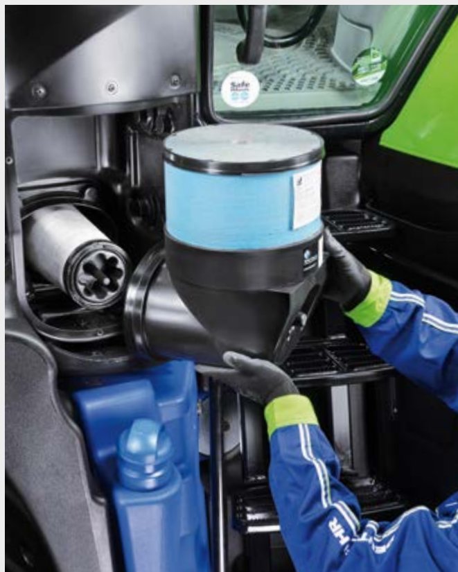
↑ L'inserimento e l'estrazione del filtro aria sono operazioni molto semplici.
