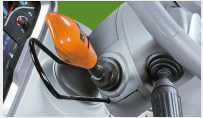
Di serie: sistema Powershuttle. La sensibilità (duro – medio – morbido) è facilmente regolabile con un comando azionabile con il pollice.
