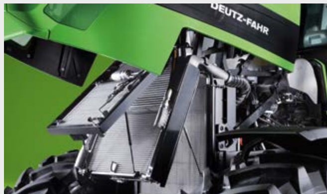
↑ Il radiatore del motore è facile da aprire e pulire.
