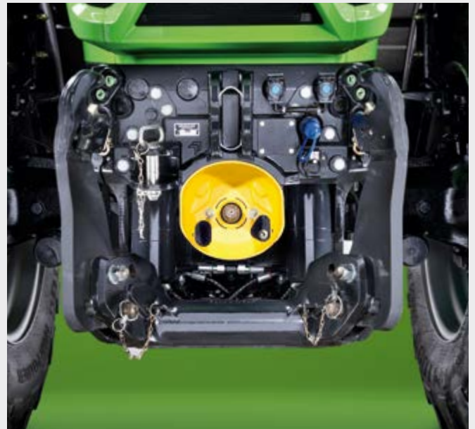
↑ Sollevatore anteriore integrato con distanza minima dall'assale anteriore. Sbalzo contenuto. Miglior bilanciamento del trattore.
