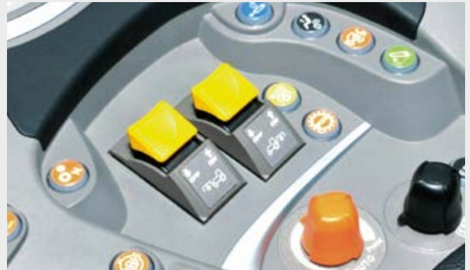
I comandi per la regolazione e l'attivazione della PTO sono integrati nel bracciolo, perfettamente a portata di mano ...
