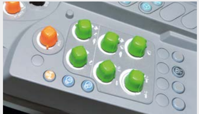
... come pure i comandi di regolazione dei sollevatori anteriore e posteriore.
