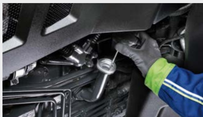
↑ Il controllo del livello olio e il rabbocco sono facilissimi.
