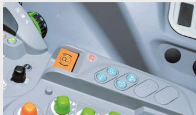
↑ EPB: sicuro innesto automatico – ogni volta che si parcheggia la Serie 9.
