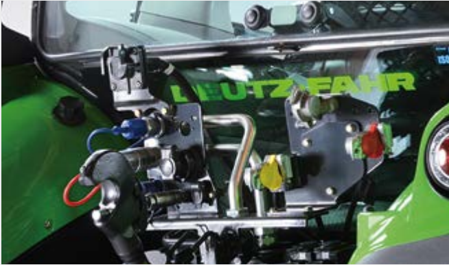
↑ L'impianto frenante ad aria compressa frenain modo affidabile e sicuro i rimorchi di qualsiasi categoria.
