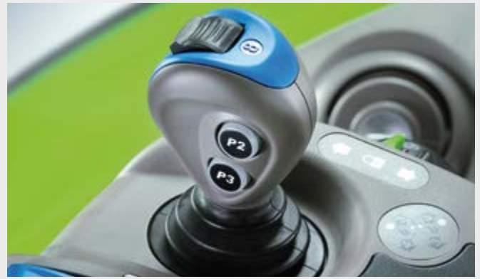
Il joystick con interruttore basculante comanda tre distributori idraulici.
