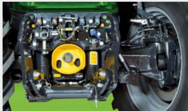
↑ Assale anteriore: Il massimo effetto ammortizzante e un angolo di sterzata massimo di 50° assicurano massima maneggevolezza.
