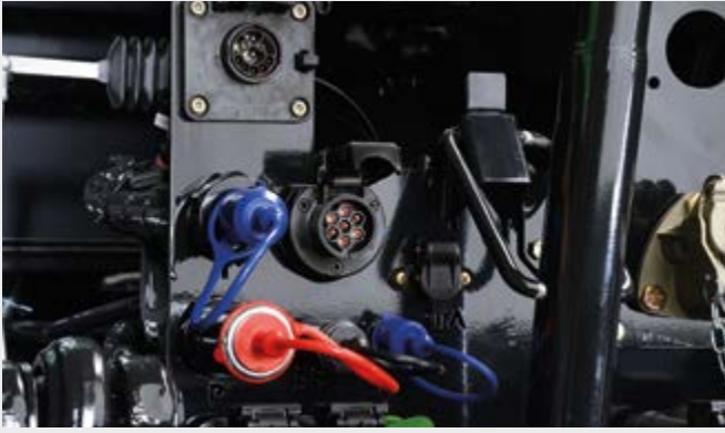
↑ Le interfacce ISOBUS DEUTZ-FAHR anteriore e posteriore rendono il trattore compatibile con le attrezzature di tutti i maggiori costruttori.
