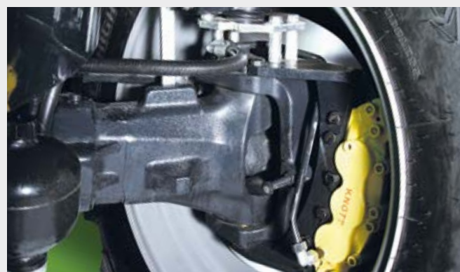
↑ Freni a disco a secco sull'assale anteriore per un effetto frenante extra-sicuro (opzionali).
