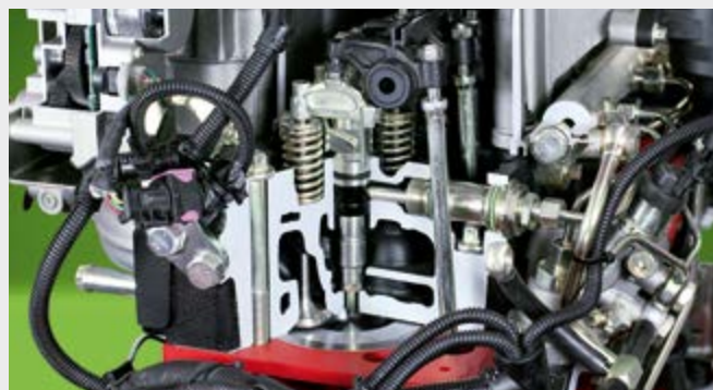
↑ Tecnologia DCR: La pressione di iniezione di 2.000 bar assicura la massima efficienza del motore.
