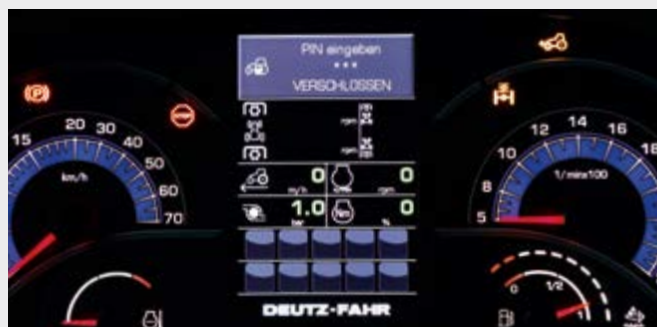
Il nuovo InfoCenter tiene l'operatore aggiornato: informazioni digitali e analogiche sullo stato operativo. Sicurezza garantita dal blocco con codice del trattore. Blocco e sblocco mediante PIN.
