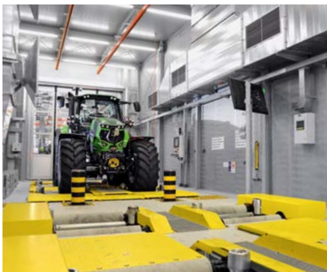
↑ Un'esclusiva nella produzione dei trattori: banco dinamometrico e banco di prova per le sospensioni degli assali.
