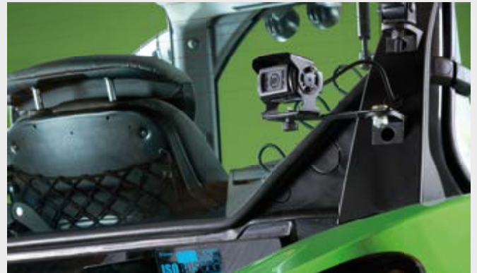
↑ Telecamera integrata con modalità a pieno schermo automatica (in retromarcia) per una buona visuale e per motivi di sicurezza.
