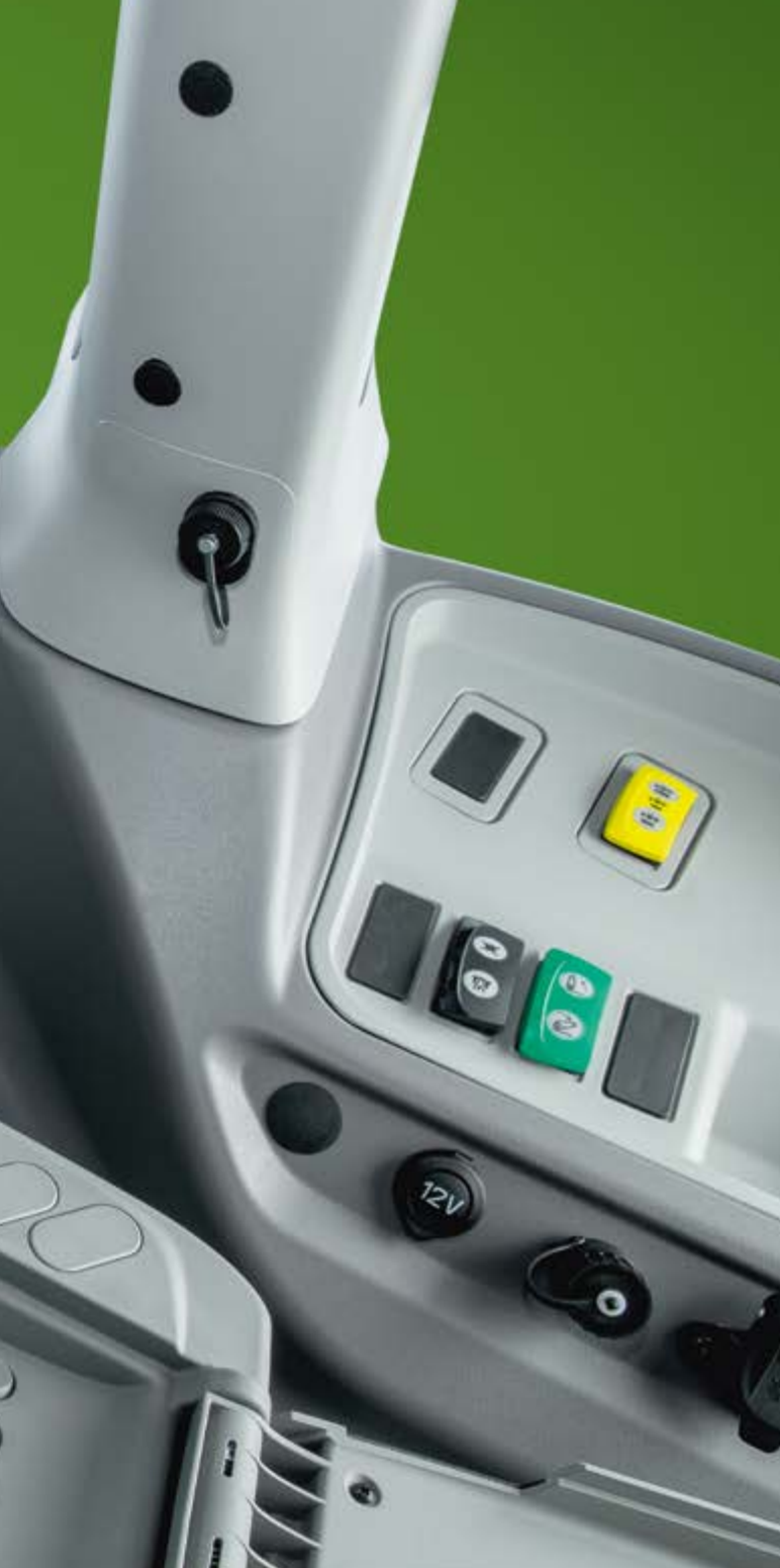
Il joystick con interruttore basculante comanda tre distributori idraulici.
