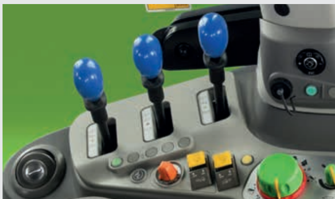
↑ Fino a 4 distributori meccanici con ergonomici comandi da un'unica leva.
