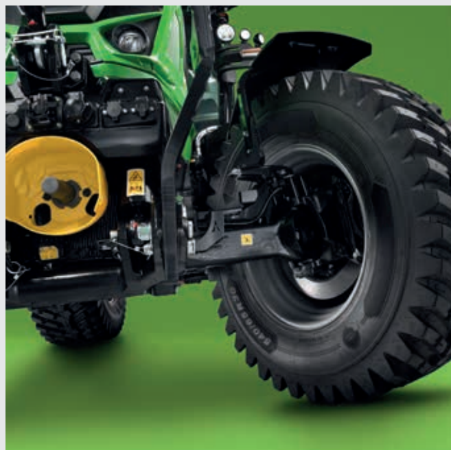
↑ I freni a disco a secco opzionali per i modelli 6210 e 6230 assicurano una straordinaria capacità di arresto.
