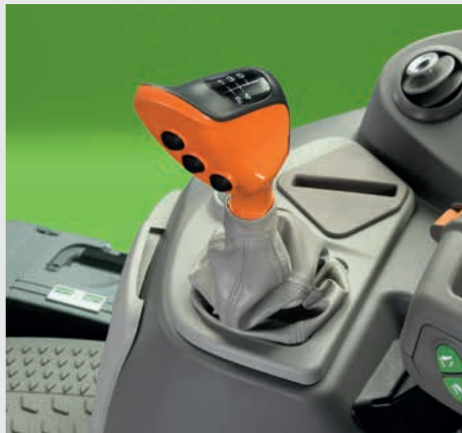
↑ Ergonomica leva del cambio con pulsanti per ComfortClutch, APS e Powershift.
