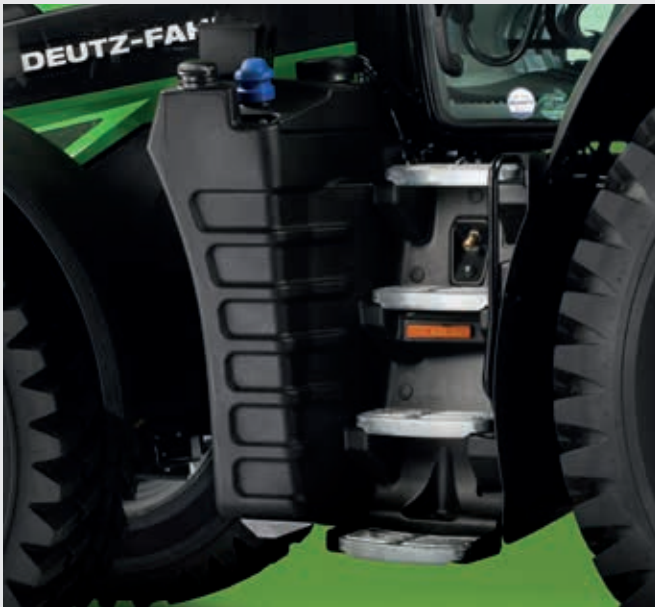
↑ Serbatoio carburante fino a 410 litri per la massima autonomia.
