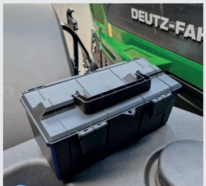
↑ Cassetta portaoggetti sopra al serbatoio carburante sul lato sinistro per tubo flessibile e pistola ad aria compressa.
