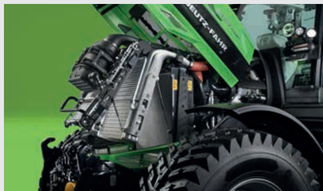
↑ Impianto di raffreddamento in alluminio dei modelli 6210 e 6230 con leva di accesso azionabile con una mano e filtro aria Powercore con sistema opzionale di prepulizia ciclonica.
