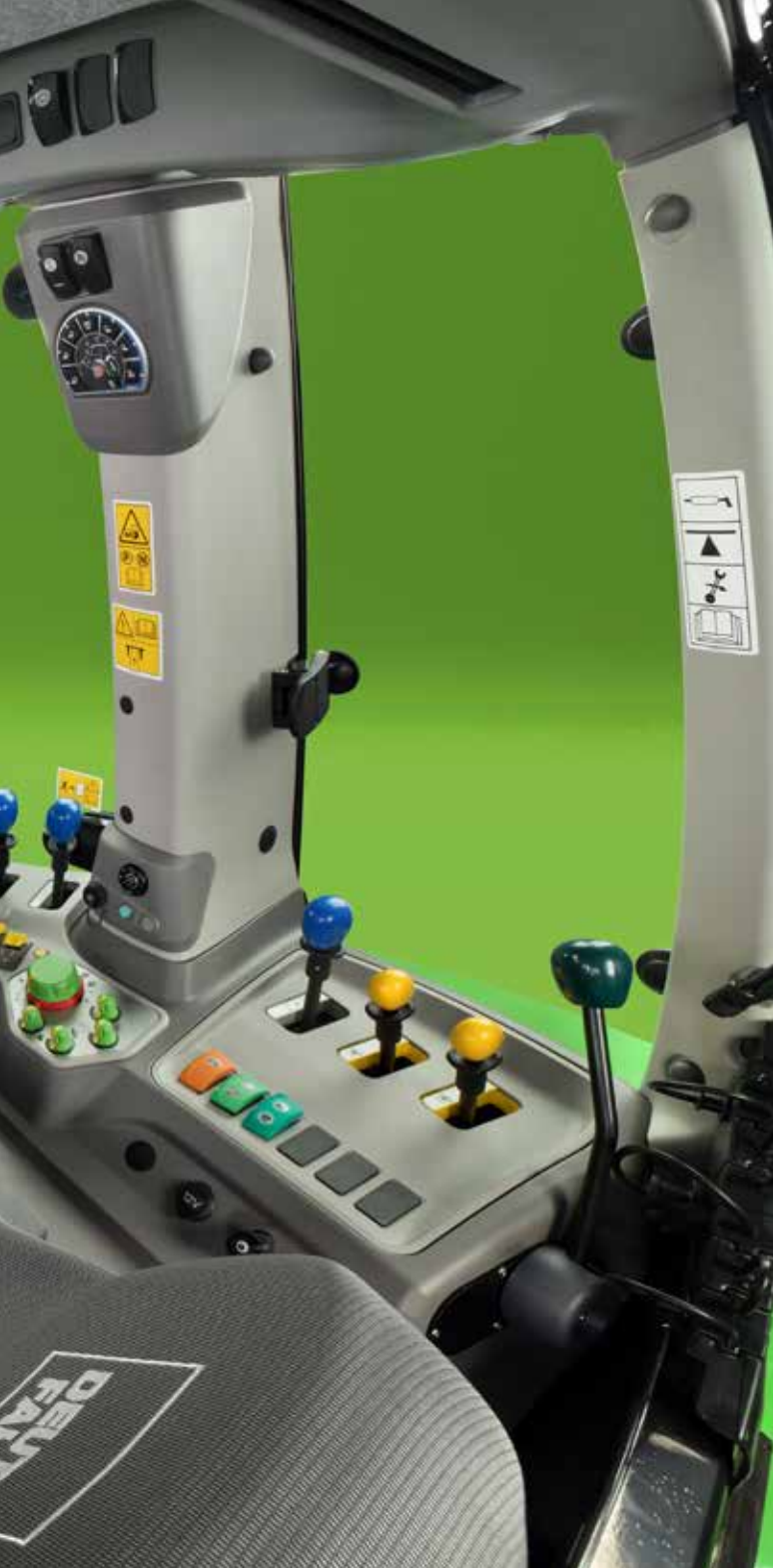
↑ L'allestimento cabina MaxiVision con distributori posteriori completamente meccanici è disponibile per i modelli Powershift (foto grande) e RCshift (foto sopra).
