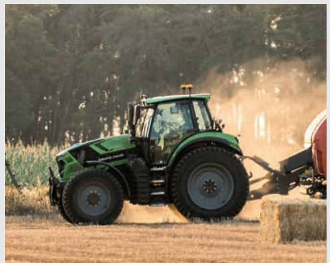
↑ Quattro velocità della presa di forza di serie per garantire la massima efficienza anche con gli attrezzi più impegnativi.
