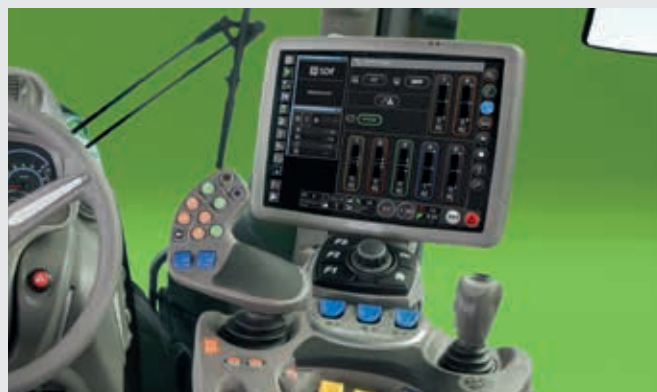
↑ Distributori elettrici con comodi elementi di controllo elettronici.
