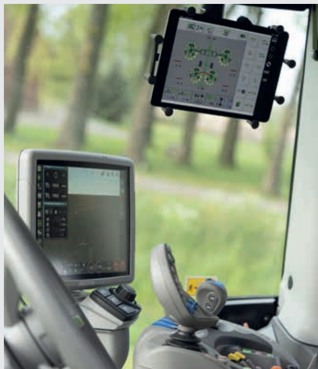
↑ La funzione XTEND consente la visualizzazione di SDF Guidance o di controllare un'attrezzatura ISOBUS su un dispositivo esterno, ad esempio un tablet.
