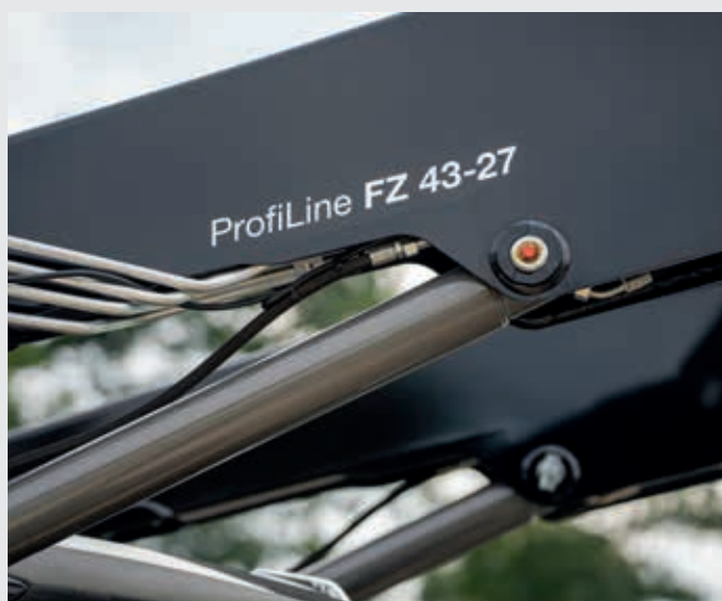
↑ I nuovi caricatori frontali Profiline raggruppano tutte le tubazioni idrauliche all'interno della traversa per la loro massima protezione e per offrire al conducente una visuale senza ostacoli.
