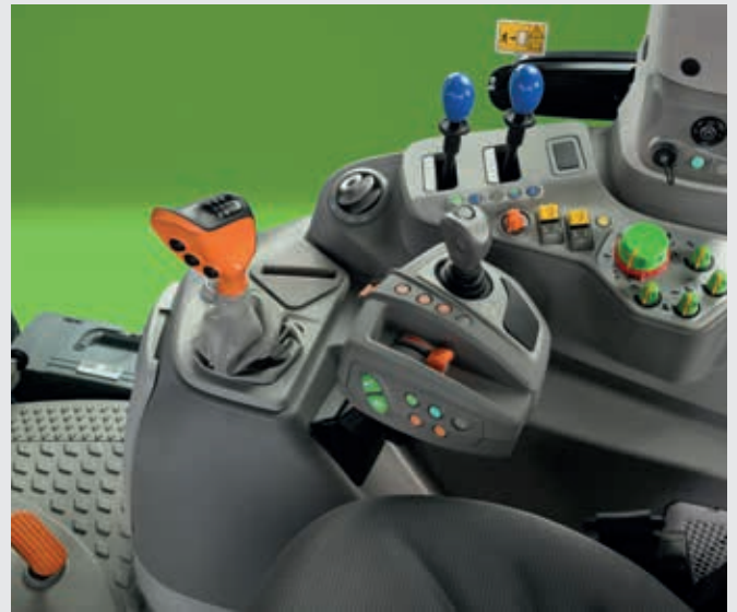
↑ L'allestimento della nuova cabina MaxiVision + con distributori posteriori misti è disponibile per i modelli Powershift (foto sopra) e RCshift (foto grande).
