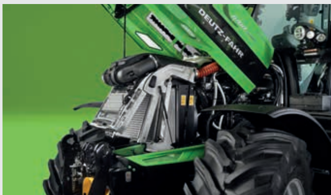
↑ Impianto di raffreddamento in alluminio dei modelli 6160.4 - 6190 con leva di accesso azionabile con una mano e filtro aria Powercore con sistema di prepulizia ciclonica.
