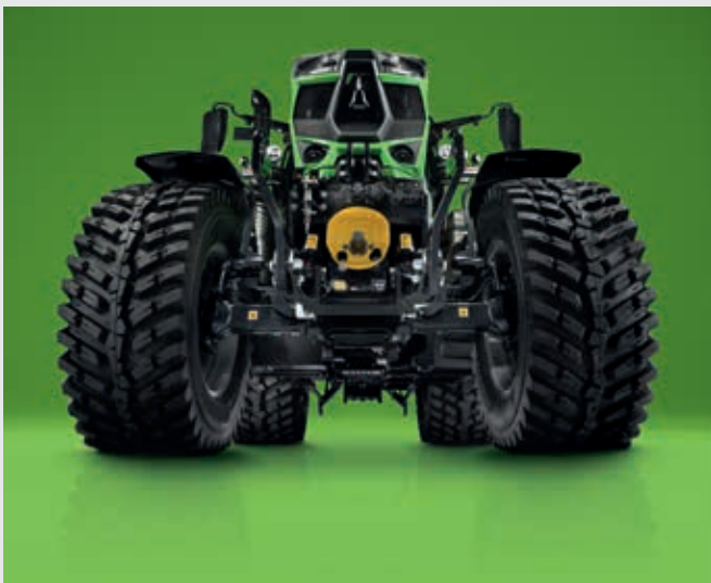
↑ Sollevatore anteriore con capacità di sollevamento massima di 5450 kg e PTO anteriore DualSpeed opzionale.
