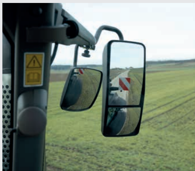
↑ Le dimensioni dei nuovi specchietti sono state aumentate del 65% garantendo così un'ottima visibilità posteriore.
