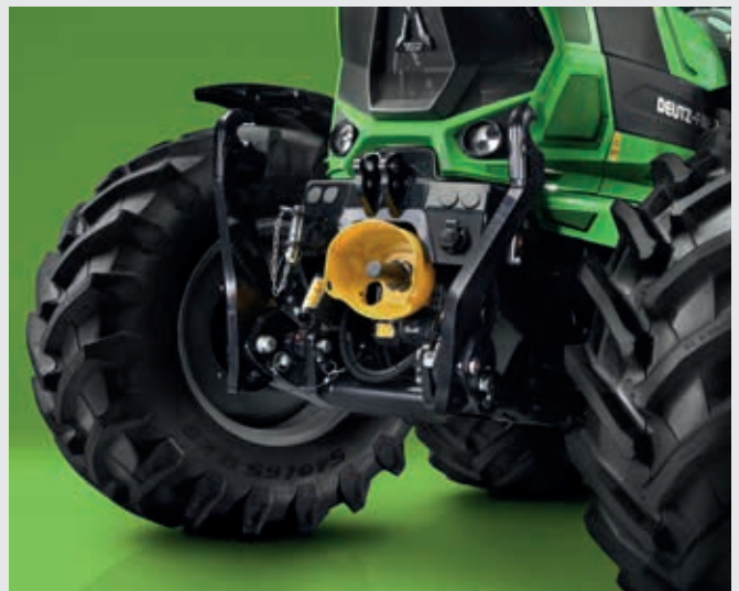
↑ Efficiente sollevatore anteriore con capacità di sollevamento massima di 3800 kg e PTO anteriore 1000 opzionale.
