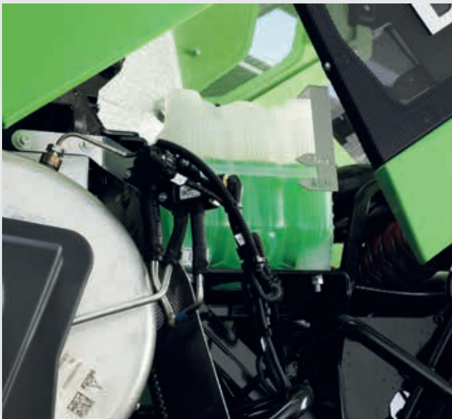
↑ Serbatoio dell'acqua con indicatore di livello in acciaio.
