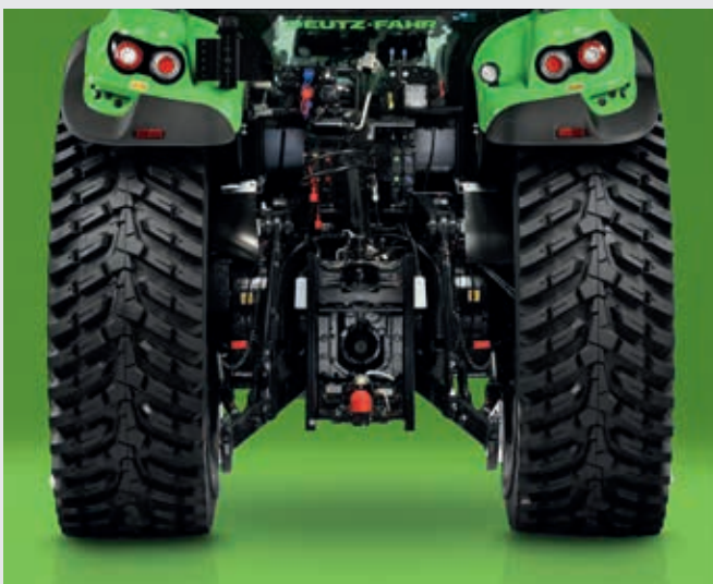
↑ Sollevatore posteriore con capacità di sollevamento massimo di 9700 kg.
