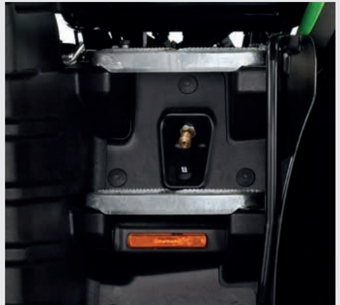
↑ Attacco per aria compressa e interruttore per luce di accesso protetti sotto i gradini.
