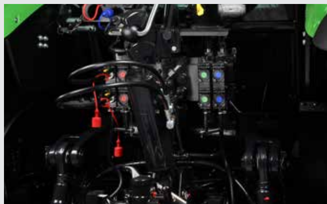
↑ Elevato comfort abbinato a facilità d'uso: configurazione idraulica mista con due distributori elettrici e due meccanici.
