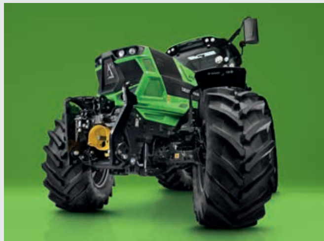
↑ I nuovi assali anteriori offrono portate superiori e integrano un nuovo sensore delle sospensioni.
