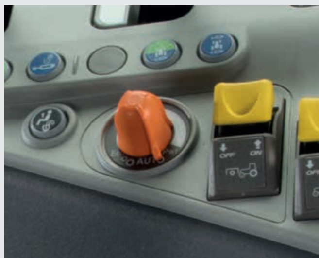
↑ Uso facile e intuitivo – con la manopola di regolazione Eco/Power l'operatore può modificare la modalità di innesto dell'APS (Automatic PowerShift).
