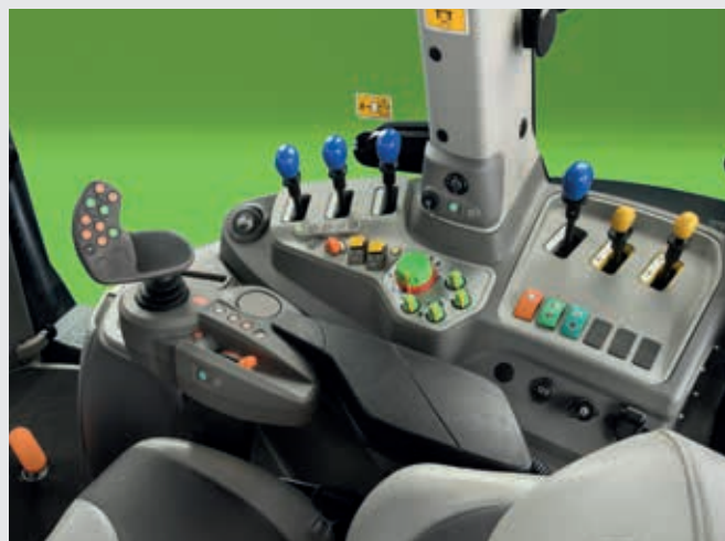
↑ L'allestimento cabina MaxiVision con distributori posteriori completamente meccanici è disponibile per i modelli Powershift (foto grande) e RCshift (foto sopra).
