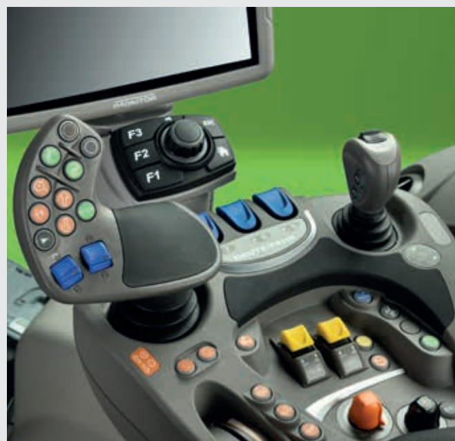
↑ Per il controllo dei distributori elettrici l'operatore può scegliere tra i comandi "fingertip" blu, il piccolo joystick o i pratici potenziometri del joystick MaxCom.
