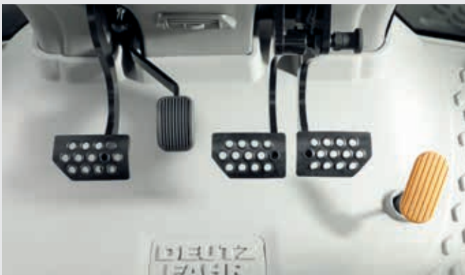
↑ Ergonomica attivazione del freno motore tramite pedale.
