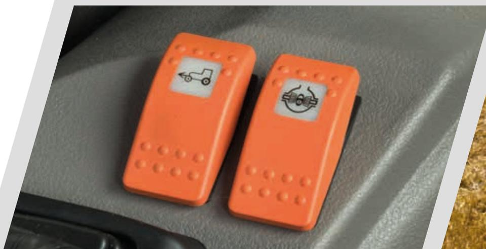
> Innesto 4RM e blocco differenziale elettroidraulico.
