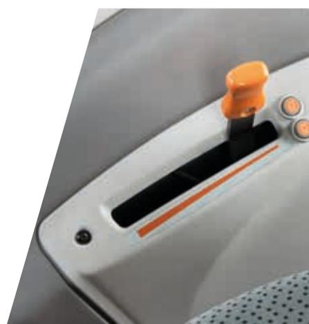
> Acceleratore manuale elettronico con due regimi motore memorizzati.
