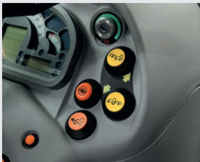
↑ Facile innesto della PTO anteriore e posteriore tramite pulsanti ergonomici.
