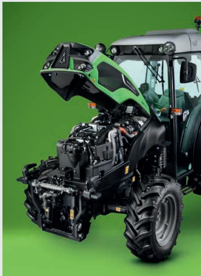
↑ Conformità a Stage V grazie ad un semplice sistema EAT. AdBlue non richiesto.
